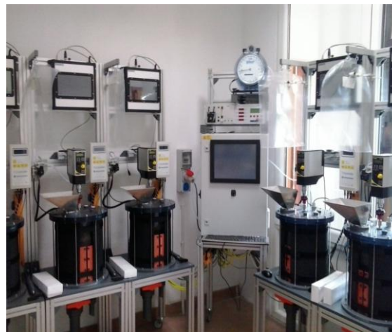
Reaktory do fermentacji ciągłej
